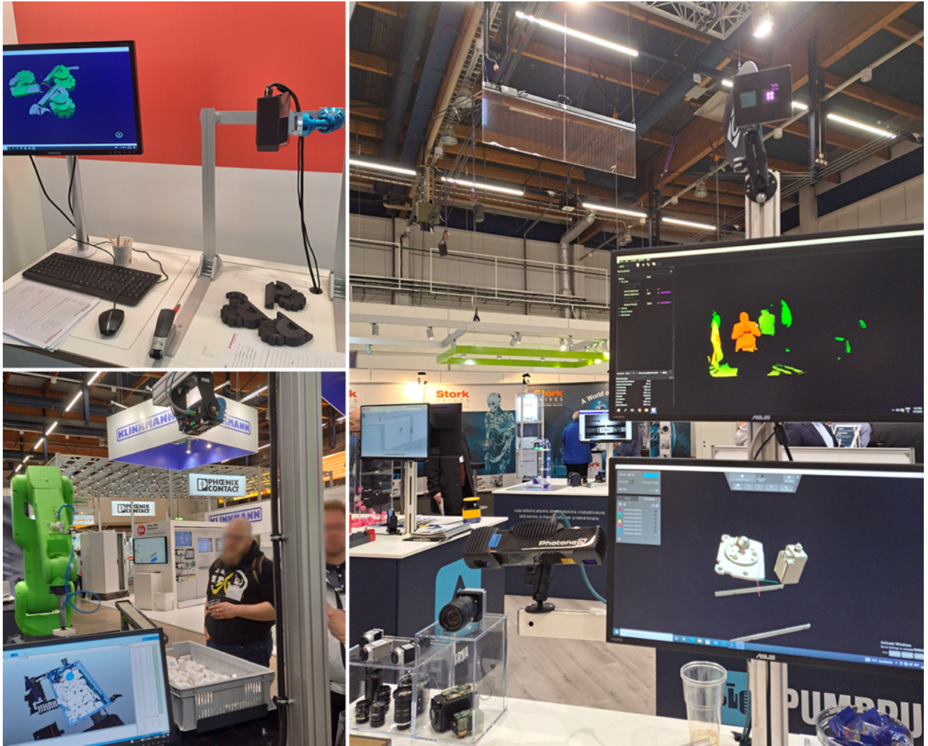
Kuva 2. 3D-kameroita vasemmalta alkaen Zividiltä, SICKiltä ja Photoneolta.
