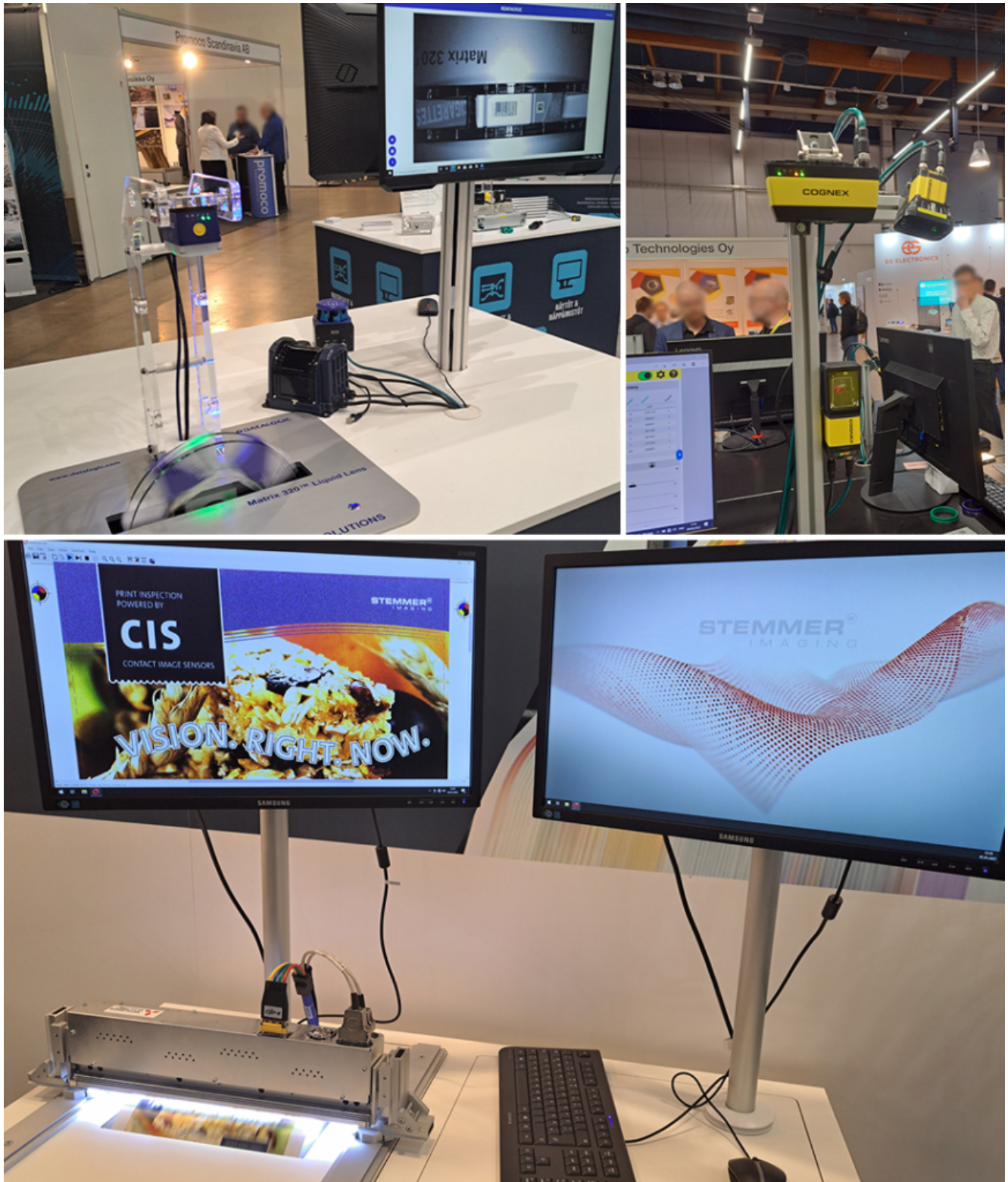
Kuva 3. Erilaisia koodinlukuratkaisuja vasemmalla ylhäällä Matrixin nestemäinen optiikka, alhaalla Mitsubishin viivakamera ja oikealla ylhäällä Cognexin stereokamera ja koodinlukijoita.
