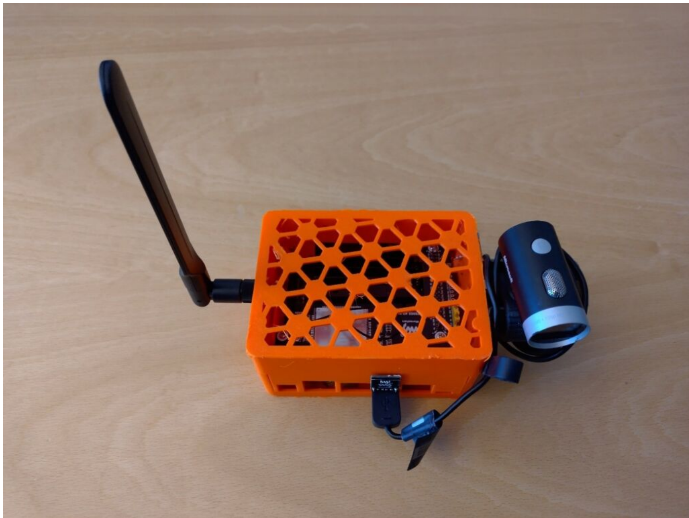
Kuva 1. Jetson Nano ja LTE-kortti 3d-tulostetussa kuossa. Laitteeseen on liitetty erillinen USB-kamera sekä LTE-kortin antenni (kuva: Tommi Ylimäki).
