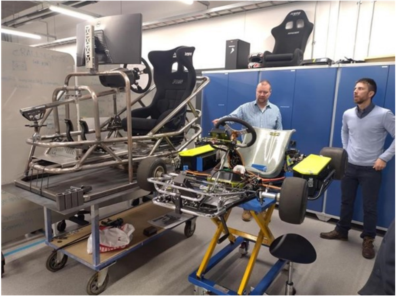
48 voltin järjestelmällä toimivien sähköisten karting-autojen rakentaminen on osa autopuolen projektiopintoja. Matalajännitejärjestelmä mahdollistaa tekemisen ilman varsinaisia sähköasennuslupia (kuva: Tommi Ylimäki).
