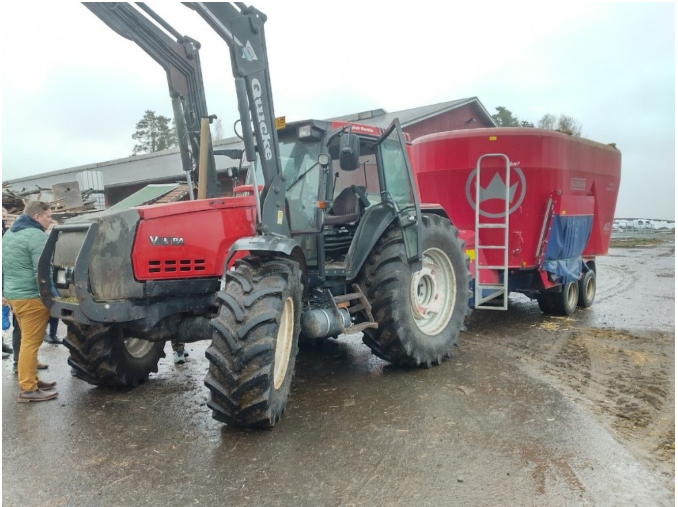
Kuva 2. Picnus Oy:n biokaasukäyttöinen traktori (Kuva: Kari Laasasenaho).
