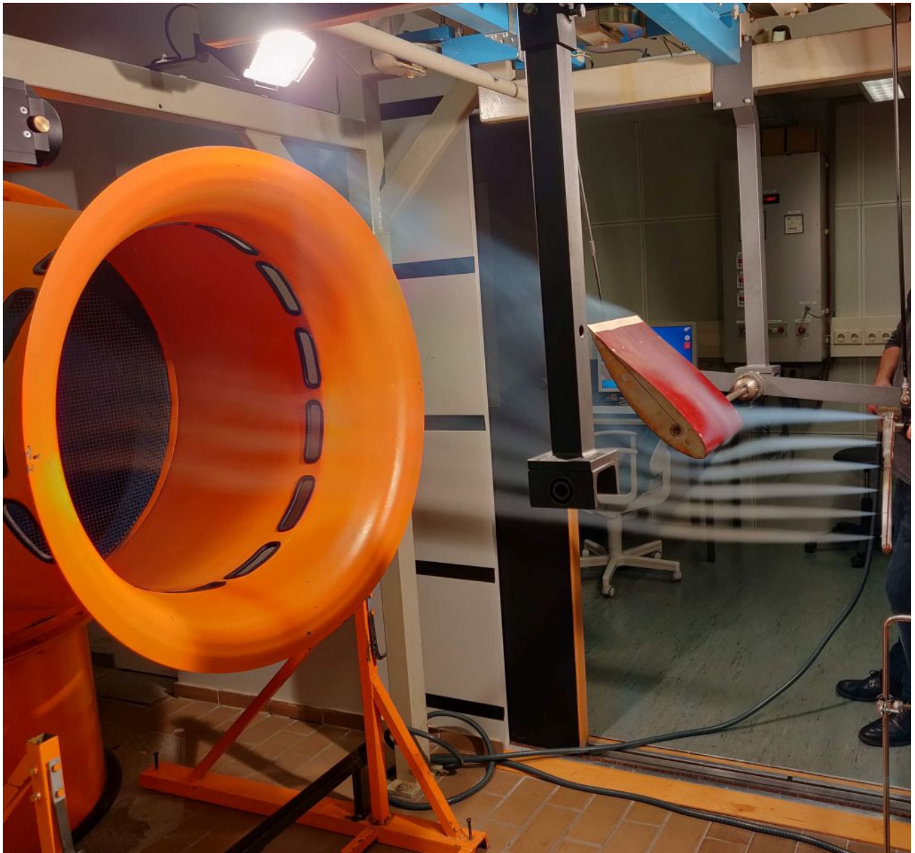
Tuulitunneli. Siipikulman vaikutus virtaukseen.
