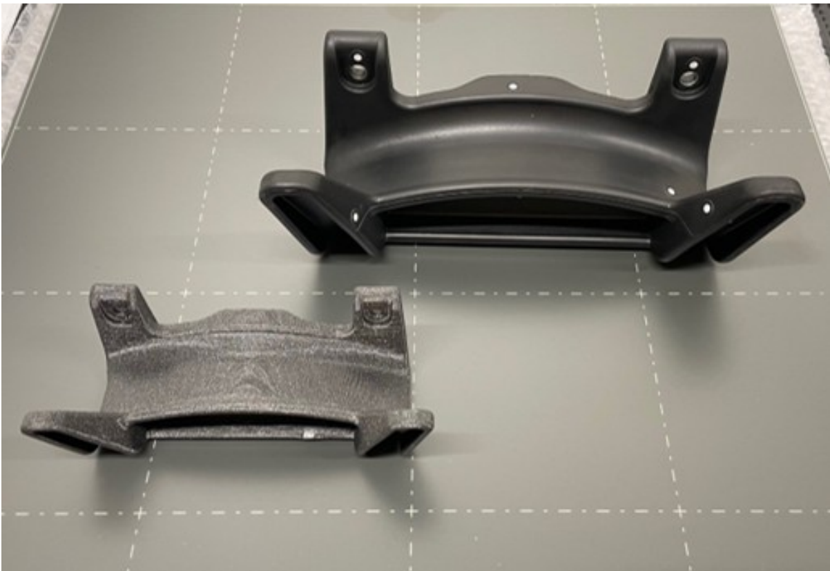
Kuva 6. Skannatun kappaleen 3D tulostettu kaksonen (kuva: Jarno Arkko, 2025).
