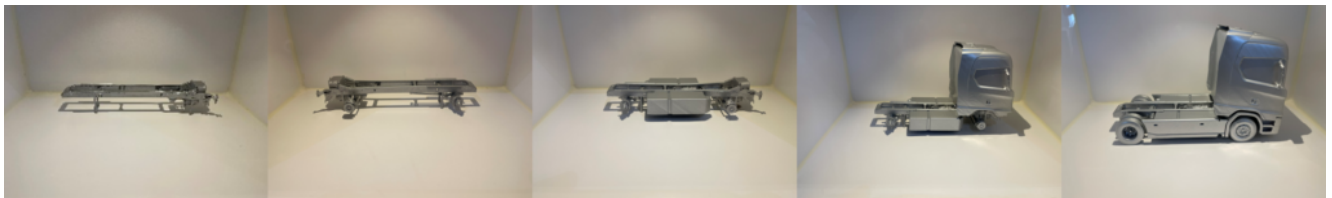
Scania kuorma-auton suurpiirteinen kokoonpanojärjestys (kuva: Jarno Arkko).
