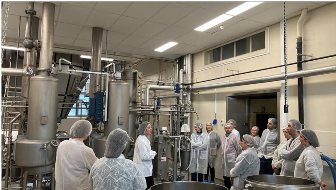
Food Pilotin spray-kuivain. Myös SeAMK Food Labsista löytyy pian vastaava laite, tosin hieman pienemmässä koossa (kuva: Elina Huhta SeAMK, 2025).
