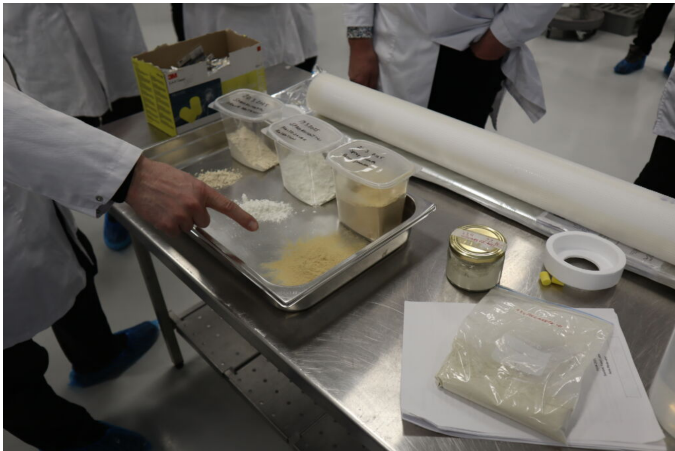
Kuva 7. Erilaisia SiccaDanian SD900-SS-spraykuivaimella kuivattuja jauheita sekä Alfa Lavalin PilotUnit Multi -membraanisuoituslaitteessa käytettävä suodatuskalvo (kuva: Jasmine Laitila, 2025).
