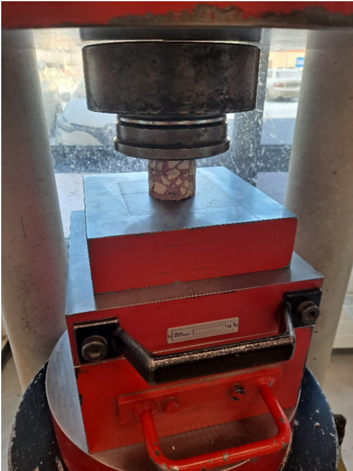
Kuva 5. Puristuslujuuden testaus (kuva: Veli Autio, 2025).
